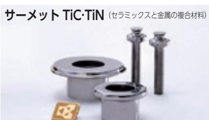
サーメット  $\text{TiC} \cdot \text{TiN}$  (セラミックスと金属の複合材料) は、炭化チタン ( $\text{TiC}$ ) や窒化チタン ( $\text{TiN}$ ) を主成分としコバルト ( $\text{Co}$ )、ニッケル ( $\text{Ni}$ )、モリブデン ( $\text{Mo}$ ) など金属との複合材料で、アルミナセラミックスの約3倍以上の強度と、優れた耐摩耗性が特長です。切削工具や工業用カッターとして、高いパフォーマンスを発揮します。また、鏡面加工により貴金属の様な輝きが得られるため、装飾部品としても利用されています。
