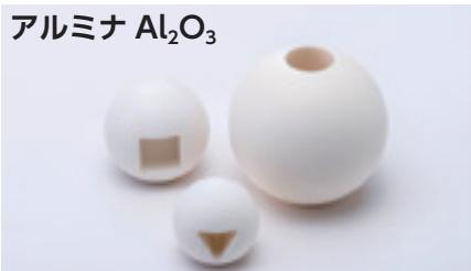
アルミナは、高い電気絶縁性を持つことからエレクトロニクス分野に早くから用いられています。また 優れた耐食性、耐摩耗性、機械的強度などの特性を兼ね備えているため、産業機械の部品にも幅広く利用されており、ファインセラミックスの中で最も多く利用されている材料です。
