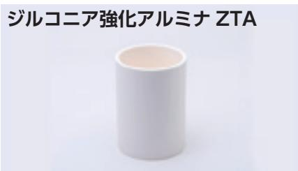
ジルコニア強化アルミナは、アルミナとジルコニアの複合材料です。アルミナ以上の硬度、曲げ強度を有し、ジルコニアよりも熱膨張が低く、高熱伝導が特徴です。高い耐摩耗性を活かし粉碎部品をはじめ、冷却を必要とする耐摩耗部品に多くご採用いただいているます。
