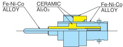
端子部分をフランジ等の取り付け部分から完全に独立させ、周囲の環境による影響(ノイズ等)を受けにくい構造の気密端子です。
